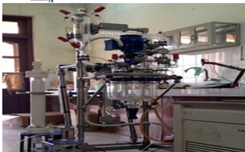
Hình 1. Thiết bị dùng để tổng hợp thuốc kháng sinh Metronidazole
